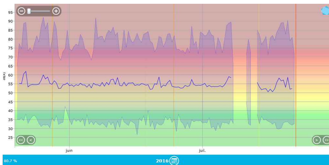
Figure 2 : évolution temporelle du niveau sonore en dB(A) pendant l'intégralité de la période d'analyse.
