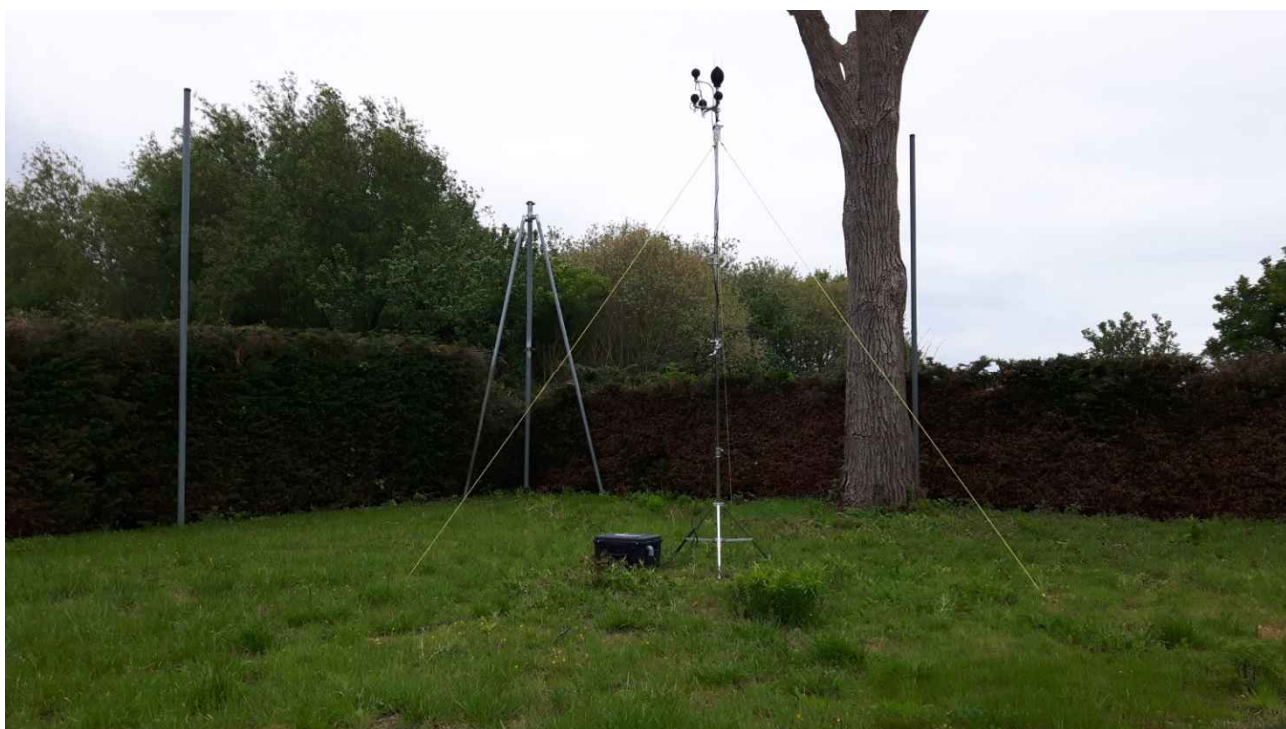
Figure 2.1 : station experte RION NA37 déployée dans le cadre de la campagne de mesure (site n°1 : Saint-Cyr-l'Ecole - rue du Docteur Vaillant).
